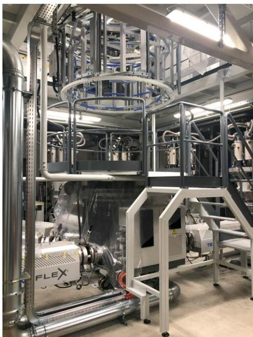
*Figura 5 -Impianto di estrusione a 7 strati di EIFFEL S.p.A.*
