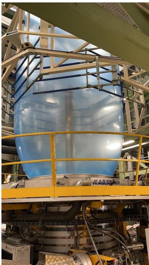
*Figura 6 - Impianto di coestruzione durante la produzione*
